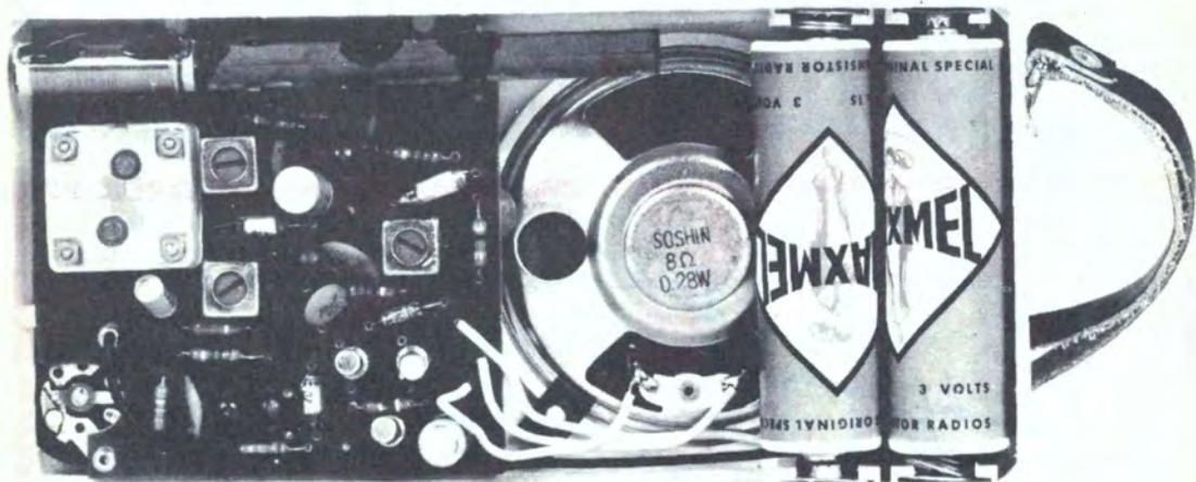
n. 2 medie frequenze; bobina oscillatrice; n. 3 condensatori elettrolitici; n. 8 condensatori normali; n. 10 resistenze; n. 4 transistor al silicio; n. 3 transistor al germanio; n. 1 diodo al germanio.
